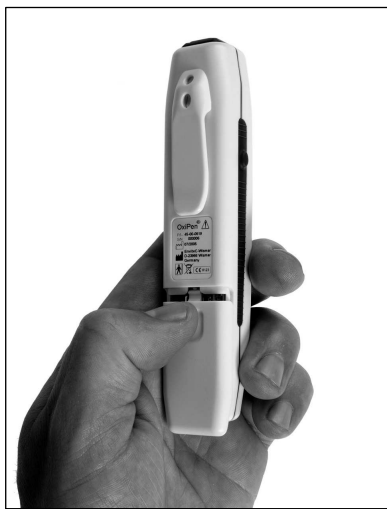
Fig. 4: Öppna locket till batterifacket
